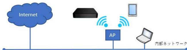
既存のネットワークに、Solstice Pod の無線クライアント機能を使って接続します。
