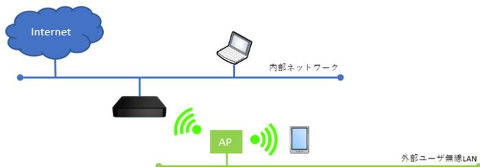
ゲスト用のネットワークが既に整備されている環境の場合は、Solstice Pod の有線 LAN を内部ネットワーク、無線 LAN をゲストネットワークに接続することにより、内部ユーザーとゲストユーザーが 1 台の Solstice Pod で同時にコンテンツを共有することができます。このとき、Solstice Pod 内部でネットワークを分割しているため、無線/有線ネットワークで相互にトラフィックが通過することはありません。
